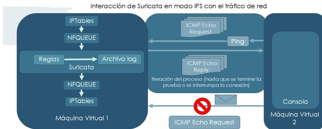
Figura 4. Interacción de Suricata en modo IPS con el tráfico de red.
